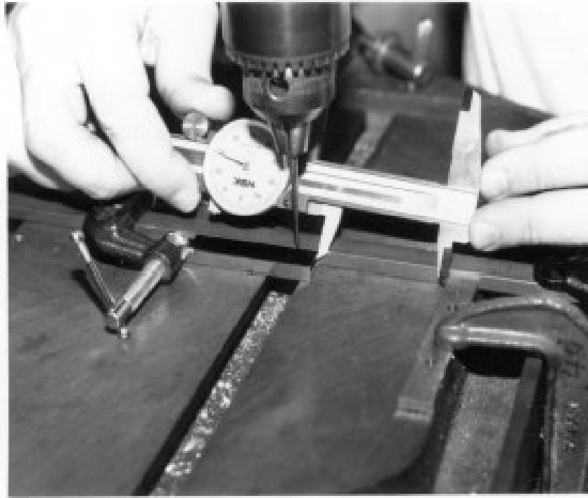
Abbildung 4: Bohrmaschineneinstellung zum präzisen Bohren von Hohlleiterfiltern. Das dunkle Objekt in der Mitte ist das zu bohrende Filter. Der Referenz Block ist im Vordergrund rechts.
